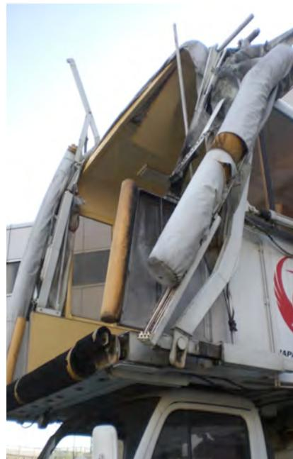
駐車中の車両へトローイングタグ車が接触した損傷事故
