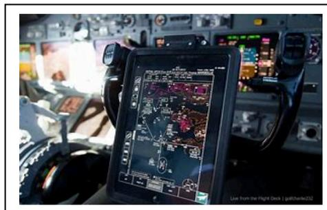
iPadのようなポータブル型をクラス1、部分装着型(電源を機体側から取得)クラス2、機体装着型で多機能ディスプレイ付きのものをクラス3としています。
