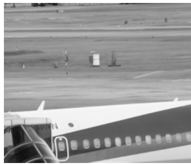
滑走路わきに設置してある雲の高さを測定するシーロメーター
